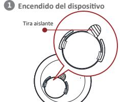
Gire el panel frontal hacia la izquierda para retirar la placa de montaje.
