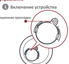
Поверните переднюю панель против часовой стрелки, чтобы снять монтажную панель.
