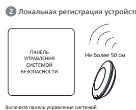
Включите панель управления системой безопасности. Нажмите кнопку функции один раз для активации датчика. Вы также можете добавить датчик, следуя голосовым инструкциям. После этого, извлеките изолационную прокладку, чтобы добиться контакта между зеленым светодиодом датчика и блоком питания 8 раз.
