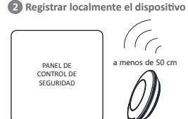
Encienda el panel de control de seguridad. Pulse el botón de función una vez cuando se despare el detector. Puede añadir el detector siguiendo las indicaciones acústicas. El led verde del detector parpadeará 8 veces cuando se haya añadido correctamente.
